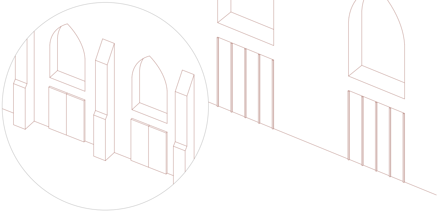
In gesloten toestand: zowel de binnenste als buitenste luiken zijn dicht. De kerktuin dringt zich niet langer op in de ruimte. Dit is nodig voor het beperken van storend lichtinval tijdens intiemere vieringen of wanneer de kerk niet gebruikt wordt.
